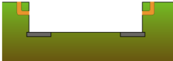
Figuur 9: afvoerpijpen voor de luchtverplaatsing
